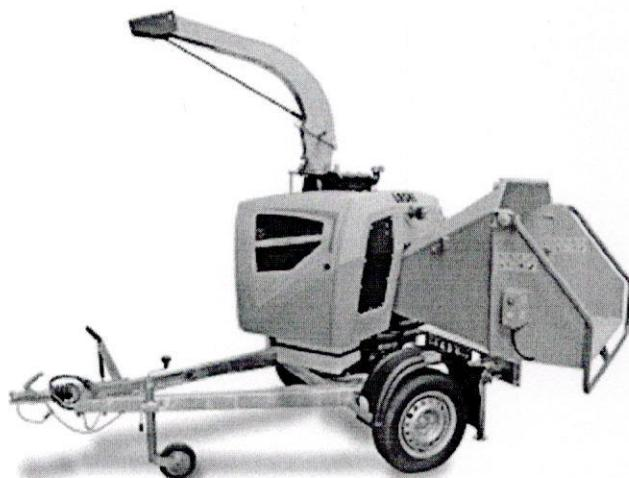
LS 160 DWB je nový kompaktní štěpkovač dřevní hmoty pro maximální průměr vkládaného materiálu 160 mm. Je určen k likvidaci větví, kmenů, keřů, kůry a dalších nadzemních částí rostlin nebo k výrobě štěpky. Otočná horní stavba štěpkovače umožňuje přímý přístup ke vkládacímu žlabu z jakékoli strany. Štěpkovač je vybaven dvěma hydraulicky poháněnými vkládacími válci s automatickým systémem druhé generace proti přetížení spalovacího motoru a vodou chlazeným motorem Lombardini o výkonu 30 HP.
